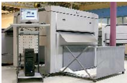
Pohled na automatický systém zakládání tiskových desek, který byl oproti předchozím modelům zcela přepracován
